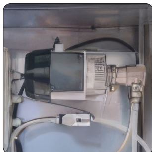
POMPE EN INOX POUR LAVE-ROUES (EN OPTION)
